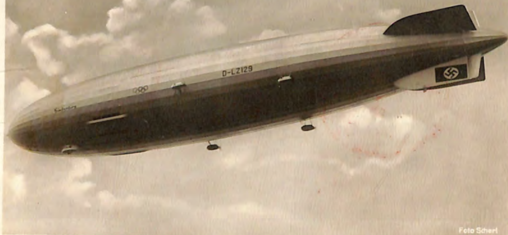
Das neue deutsche Zeppelin-Luftschiff „Hindenburg“ L. Z. 129 Das größte Luftschiff der Welt. Länge 248 m. Höhe 44,7 m, größter Durchmesser 41,2 m. Vortriebsmaschinen: 4 Mercedes-Benz Dieselmotore von je 1100 PS Geschwindigkeit von etwa 130 Stdkm.
