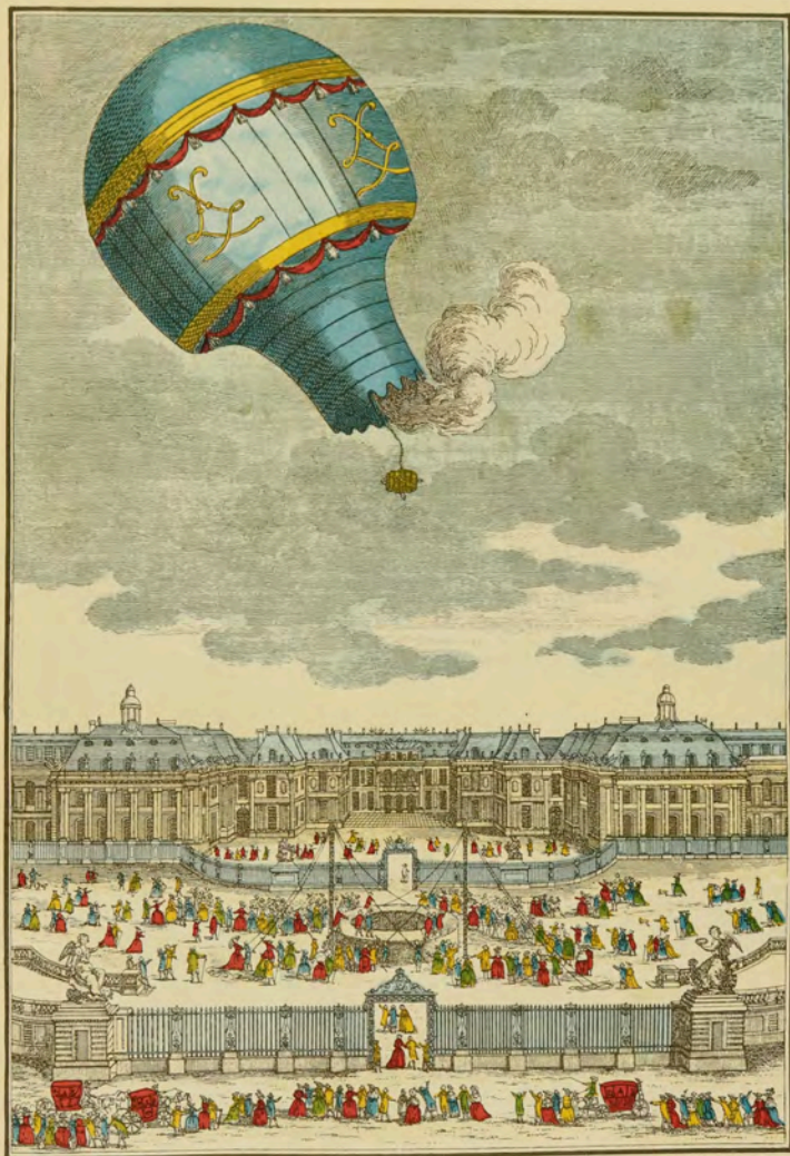
LE GLOBE AÉROSTATIQUE construit à Versailles a été placé dans la 1 re Cour du Château, dite Cour des Ministres, sur un échafaud de 60 pieds carré et 8 de hauteur. Environ 200 Ouvriers travaillaient aux préparatifs, et le tout étoit enfermé d'une toile pour empêcher le Public de voir ce qu'il se passoit. — Le Globe de la capacité de 60 pieds de haut et 40 de diamètre, fond d'acier, son pavillon et ses énormes volutes d'or contenant 4000 pieds cubes de Gaze, pouvoit enlever douze cent livres pèse, cependant il n'a été chargé que de six cent, sans compter ses poids qui étoient de 8 cent, on y a attaché une cage de bois, depuis étoit enfermé en acier, et le 15 me août 1783 il a levé après midi, sans être rempli d'air inflammable, il s'est envolé en présence du Roi et de la Famille Royale. Sa cage étoit fermée avec la machine pour le couchant un angle de 15 de degrés 40 min. l'angle au sommet de l'horizon étoit d'un deg 55 m 55 sec. ce qui donne une hauteur de 295 toises au dessus du res-de-chaussée de l'Observatoire. Le diamètre apparent étoit d'environ 60 toises, ce qui indiquant que la machine s'approchoit de l'Observatoire, et on étoit à la portée pour tirer à deux toises du point de son départ au drapeau Marquis, dans le Bois de Vincennes près le chemin aux Bœufs où il s'est tombé.
